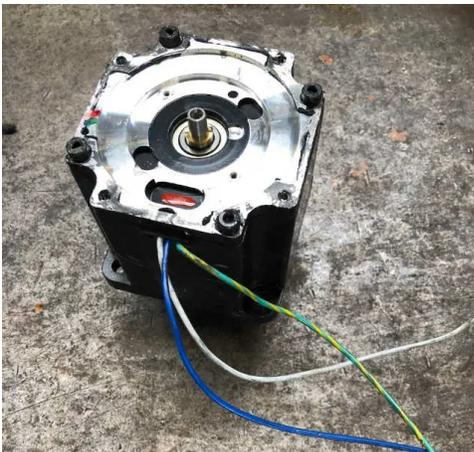
Messtechnisch ergab der Wicklungswiderstand der UVW Phasen im Vergleich zu einem Originalmotor unterschiedliche Werte.
